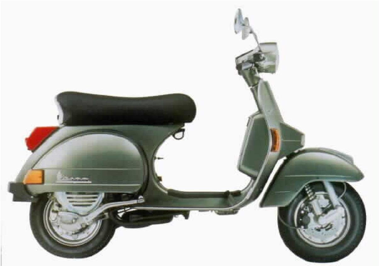
Nell' immagine sotto: Vespa M18 (PX) anno 1999, con freno anteriore a disco e per la prima volta catalizzata (euro1)
